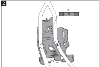
Make sure that all the hooks of the skidplate are well engaged at the frame and lay the bracket (C) into the appropriate seat. Assicurarsi che tutti i ganci del sottomotore siano ben incastrati al telaio ed appoggiare la staffa (C) nell'apposita sede.
